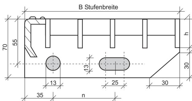
Treppenstufen haben Seitenbleche mit zwei Löchern und gelöcherter rutschhemmender Leiste
